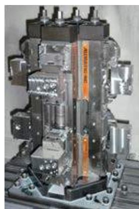
DUO 125 4 x 90° mit breitenreduzierten Sonderbacken für 1. und 2. Spannung
