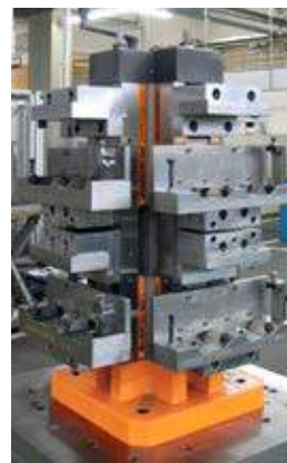
Monoblock DUO 125 4 x 90° in Sonderausführung zur Bearbeitung komplexer Gussteile
