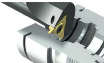
Wendeschneidplatten zur Herstellung von Sicherungsringnuten innen und außen nach DIN 471/472, sowie DIN 983/984. Nutnennbreiten von 0,5 mm bis 5,15 mm. Auch erhältlich mit geschliffener Spanformrinne oder mit Nutaußenkantenfasung.
