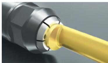
Klemhalter mit innovativem „ME“-Spannprinzip zum kraftschlüssigen Umspannen des Schneideinsatzes. Vier verschiedene Kühlmittelzufuhrarten (R, L, R+L oder Kühlung durch den Schneideinsatz) je nach Bedarf einstellbar.
