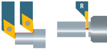
Ausführung «TWIN» mit Innenkühlung
