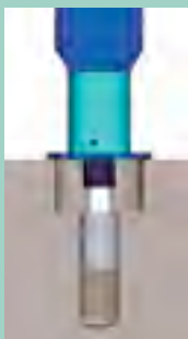
Durchmesservergrößerung für größere Anlageflächen.
