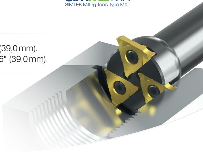
Sistema que consta de fresadora de disco, cabezal porta insertos o fresa de ranurar y plaquita de corte de metal duro intercambiable con 3 filos. Entre 2 y 20 plaquitas de fresado por porta herramientas. Para las altas exigencias de precisión y estabilidad durante el fresado circular en agujeros a partir de Ø 1.536" (39,0mm).
