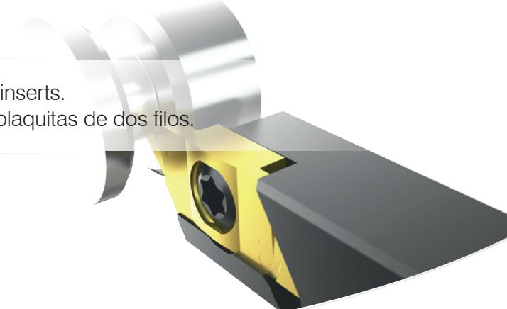
El sistema de herramientas simturn K2 fue diseñado para satisfacer las más altas expectativas en el mecanizado de plaquitas para tronzar y ranurar piezas pequeñas. El sistema consta de plaquita con doble filo y un porta-herramienta especialmente diseñado para torno tipo Swiss. Ideal para el mecanizado exterior.
